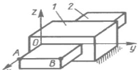
**Вопрос 6.** В корпусе 1 по направляющим перемещается ползун 2 по закону  $x_A = 0,1\cos(t)$ ,  $z_A = 0$ . В момент времени (с)  $t' = \pi$  определить скорость точки B, если расстояние AB = 0,3 м.
