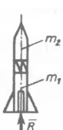
**Вопрос 10.** Двухступенчатая ракета в момент пуска с поверхности Земли в вертикальном направлении развивает реактивную силу  $R = 90 \text{ кН}$ . Массы ступеней ракеты равны  $m_1 = 200 \text{ кг}$ ,  $m_2 = 100 \text{ кг}$ . Определить силу давления в кН между ступенями ракеты в момент пуска.
