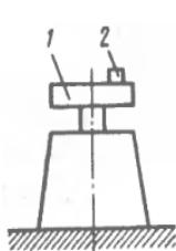
**Вопрос 9.** Горизонтальная платформа вибростенда 1 совершает в вертикальном направлении гармонические колебания с амплитудой 8 мм и частотой 8 Гц. К платформе прикреплен датчик 2 массой 50 г. Определить максимальное значение силы, которая стремится оторвать датчик от платформы.
