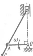
**Вопрос 7.** Определить угловую скорость кривошипа OA в указанном положении, если скорость точки C шатуна  $V_C=4 \text{ м/с}$ , длина кривошипа  $OA=0,2 \text{ м}$ .
