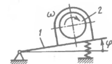
**Вопрос 10.** Платформа 1 совершает колебания по закону  $\varphi = 0,1 \cdot \sin(10\pi \cdot t)$ . Якорь 2 двигателя вращается относительно статора с угловой скоростью  $\omega = 7 \text{ рад/с}$ . Определить максимальное значение абсолютной угловой скорости якоря.
