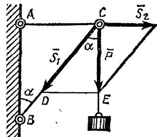
13. Фонарь весом  $P=200$  Н подвешен на двух тросах  $AC$  и  $BC$ , образующих с горизонтальной прямой одинаковые углы  $\alpha=5^\circ$ . Определить, с какой силой натянуты тросы.
