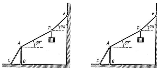
7. Груз весом  $G = 518H$  подвешен в точке  $D$  к канату  $ADE$ , участок которого  $AD$  составляет с горизонталью угол  $30^\circ$ , а участок  $DE$  – угол  $45^\circ$ . В точке  $A$  канат привязан к вертикальному столбу  $AB$ , поддерживаемому подкосом  $AC$ , наклоненным к горизонтали под углом  $60^\circ$ . Чему равно усилие в столбе?
