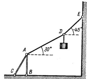
6. Груз весом  $G = 518H$  подвешен в точке  $D$  к канату  $ADE$ , участок которого  $AD$  составляет с горизонталью угол  $30^\circ$ , а участок  $DE$  – угол  $45^\circ$ . В точке  $A$  канат привязан к вертикальному столбу  $AB$ , поддерживаемому подкосом  $AC$ , наклоненным к горизонтали под углом  $60^\circ$ . Чему равно натяжение каната на участке  $DE$ ?
