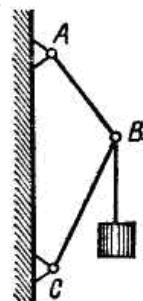
4. Кран состоит из цепи  $AB = 1,2$  м и подкоса  $CB = 1,6$  м, прикрепленных к вертикальной стойке в точках  $A$  и  $C$ , причем  $AC = 2,4$  м. В точке  $B$  подвешен груз весом  $G = 30$  кН. Чему равно усилие в подкосе?
