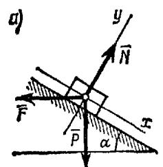
15. Груз весом  $P$  лежит на гладкой наклонной плоскости с углом наклона  $\alpha$ . Определить, значение силы давления  $N$  груза на плоскость, чтобы удержать его в равновесии.
