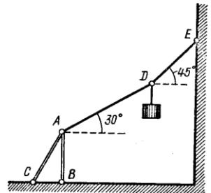
9. Груз весом  $G=518H$  подвешен в точке  $D$  к канату  $ADE$ , участок которого  $AD$  составляет с горизонталью угол  $30^\circ$ , а участок  $DE$  – угол  $45^\circ$ . В точке  $A$  канат привязан к вертикальному столбу  $AB$ , поддерживающему подкосом  $AC$ , наклоненным к горизонтали под углом  $60^\circ$ . Определить какой вид деформации испытывает столб?
