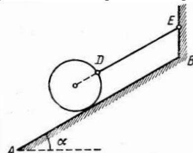
2. На гладкой наклонной плоскости  $AB$ , образующей с горизонтом угол  $\alpha = 30^\circ$  при помощи веревки  $DE$ , параллельной плоскости  $AB$ , удерживается однородный шар весом  $G=4$  Н. Чему равно натяжение веревки?
