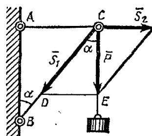
11. Кронштейн состоит из стержней  $AC$  и  $BC$ , соединенных со стеной и друг с другом шарнирами, причем угол  $BAC=90^\circ$ , угол  $ABC=\alpha$ . В точке  $C$  подведен груз весом  $P$ . Чему равно усилие в стержне  $S_1$ ?
