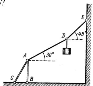
10. Груз весом  $G=518H$  подвешен в точке  $D$  к канату  $ADE$ , участок которого  $AD$  составляет с горизонталью угол  $30^\circ$ , а участок  $DE$  – угол  $45^\circ$ . В точке  $A$  канат привязан к вертикальному столбу  $AB$ , поддерживающему подкосом  $AC$ , наклоненным к горизонтали под углом  $60^\circ$ . Определить какой вид деформации испытывает подкос?
