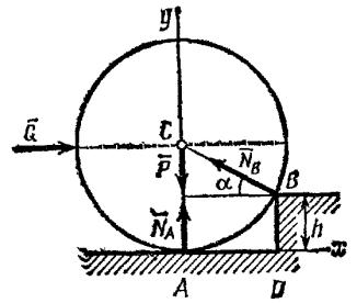
17. На цилиндр весом  $P$ , лежащий на гладкой горизонтальной плоскости, действует горизонтальная сила  $Q$ , прижимающая его к выступу  $B$ .
